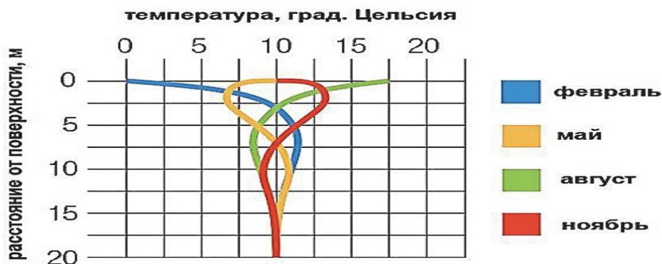
Рис. 1. Распределение температур в поверхностном слое земли[1]
