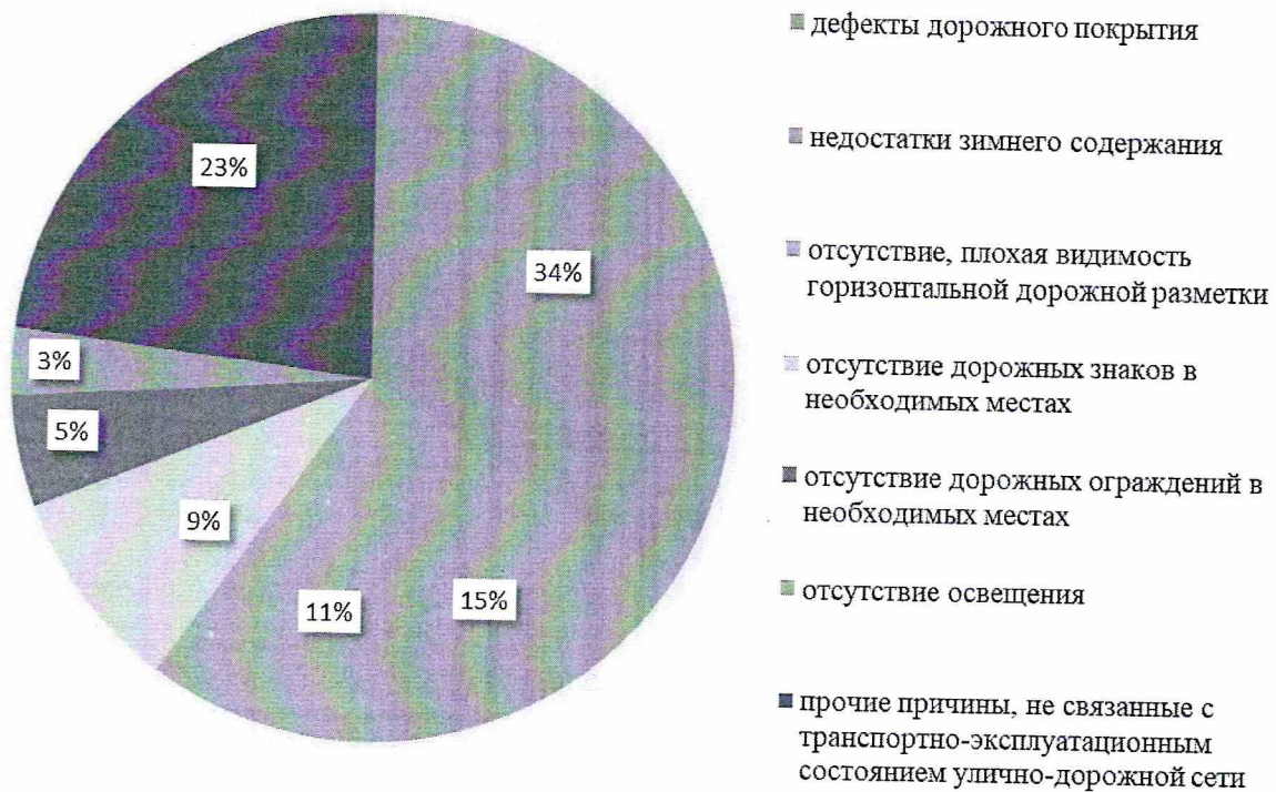
Рисунок 2. Основные недостатки транспортно-эксплуатационного состояния улично-дорожной сети
