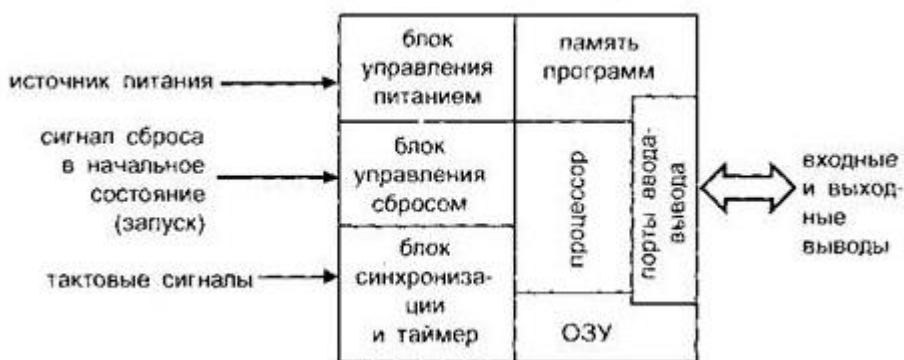
Рисунок 8 - Общая структура микроконтроллера
