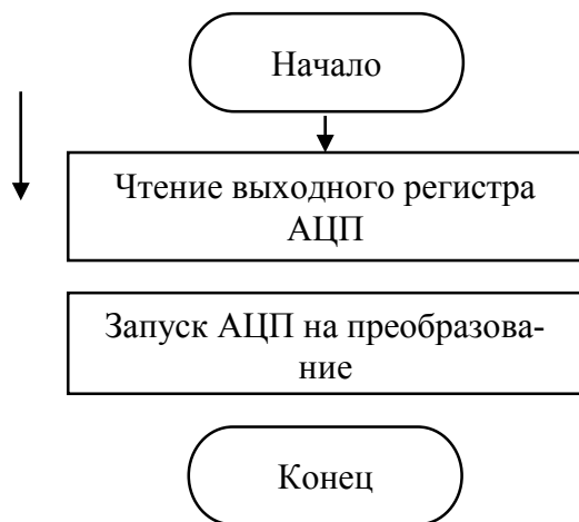
Рисунок А18 – Блок схема опроса АЦП в прерывании ADC_INT
