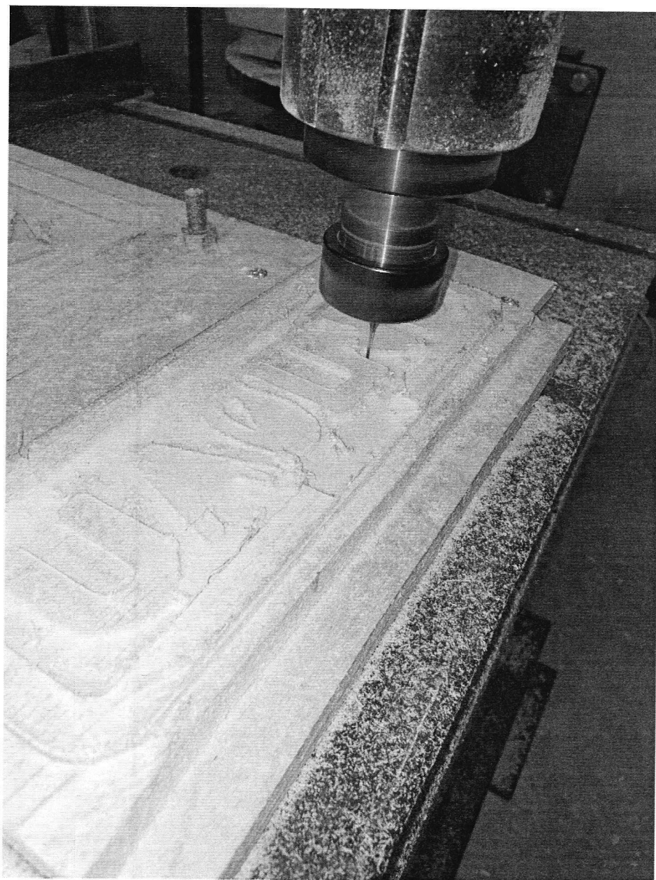
Рисунок 1.4 – Процесс фрезеровки табличек
