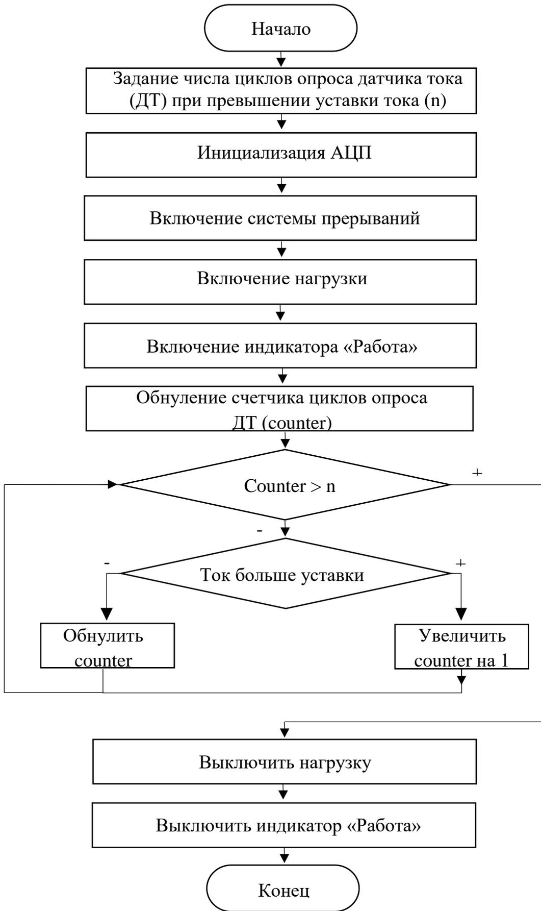
Рисунок А11 – Блок-схема алгоритма управляющей программы
