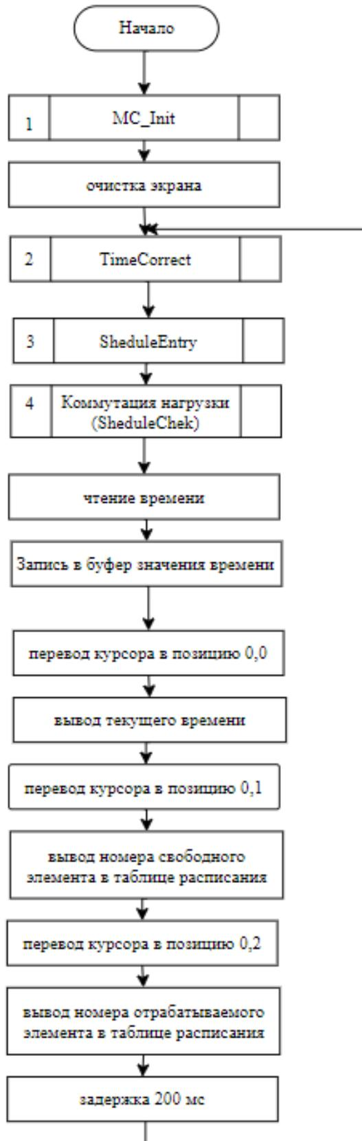
Рисунок Б1 - Алгоритм работы основной программы
