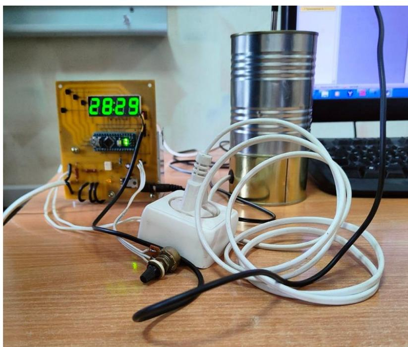
Рисунок А6 – Тестирование изделия (температура с задатчика 28 °С, с датчика 29 °С – нагревательная лампа выключена)
