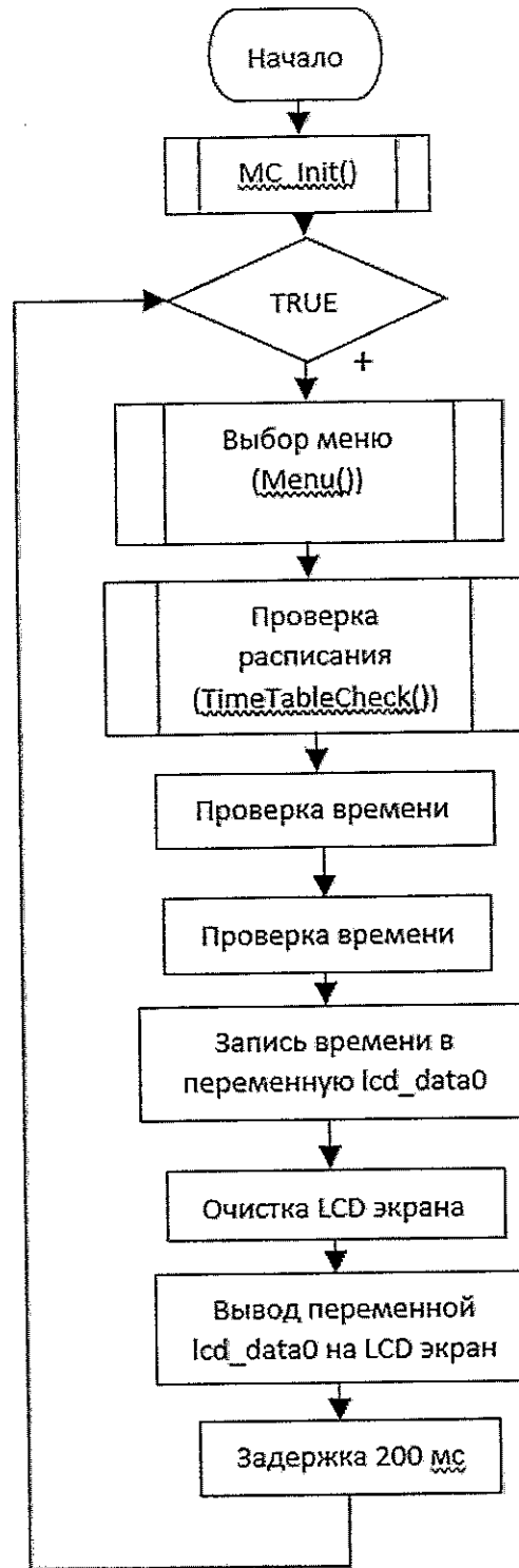
Рисунок А5 - Блок схема void main
