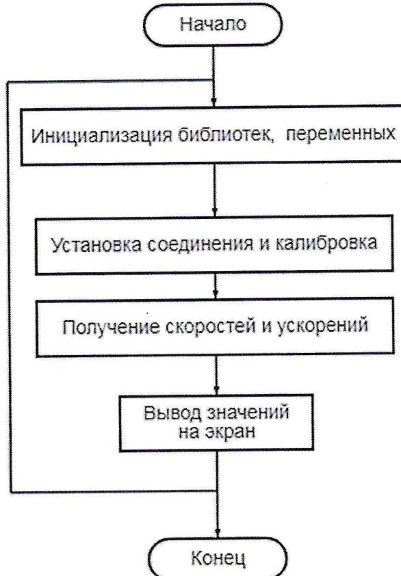
Рисунок А8 – Блок-схема управляющей программы
