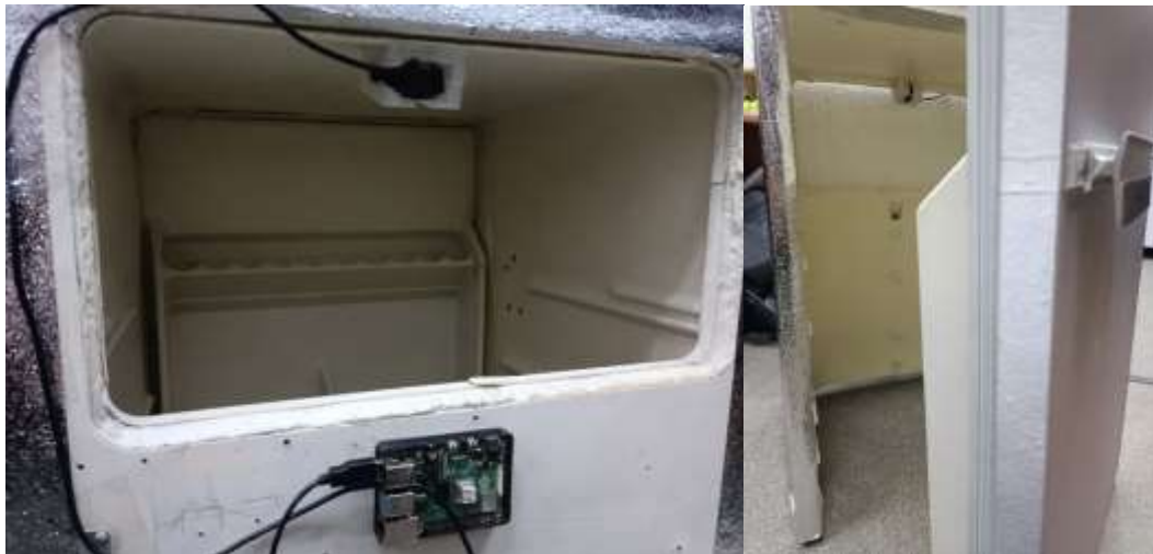
Рисунок Б2 – Пример установки работающего прототипа в настоящий ХОЛОДИЛЬНИК
