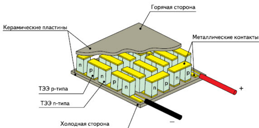
Рисунок 3 – Термоэлектрический генераторный модуль в разрезе
