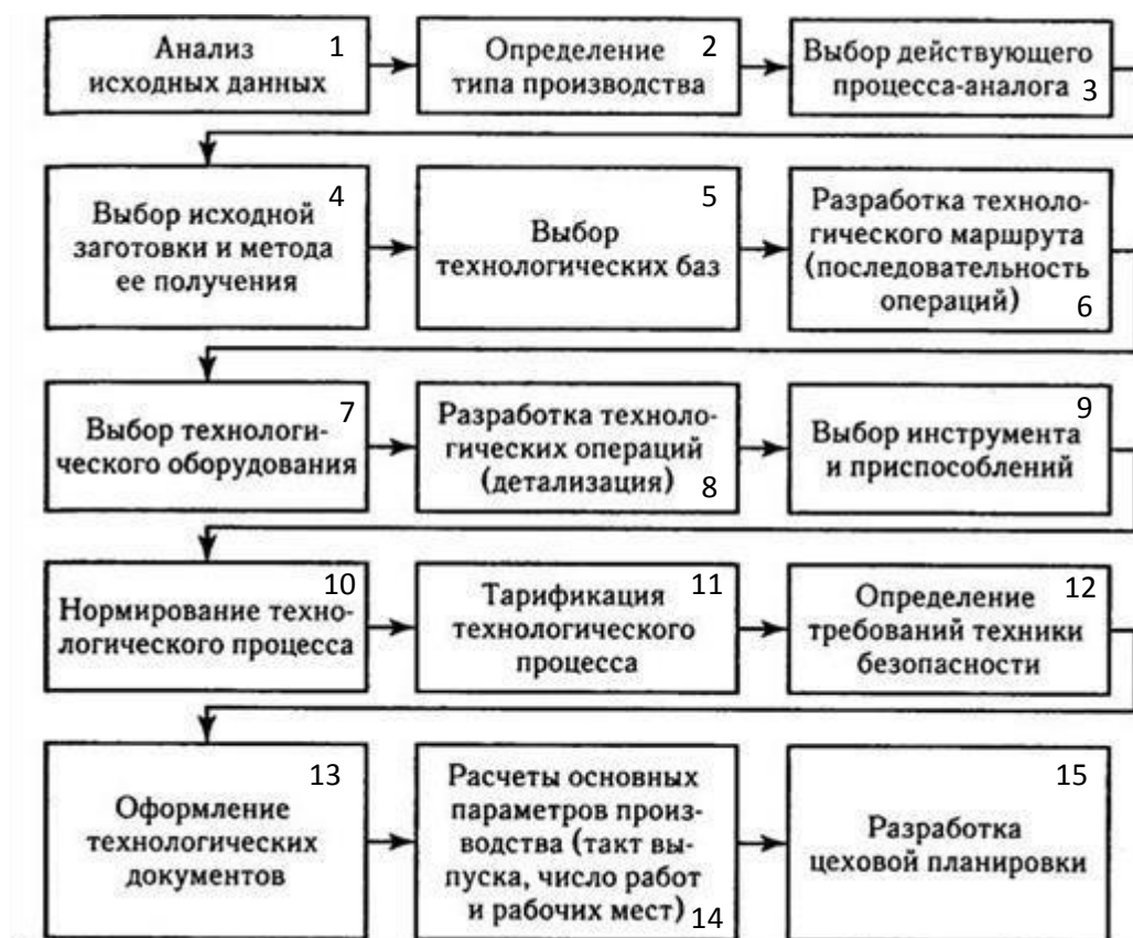
Рисунок 2 – Общая схема последовательности разработки технологического процесса
