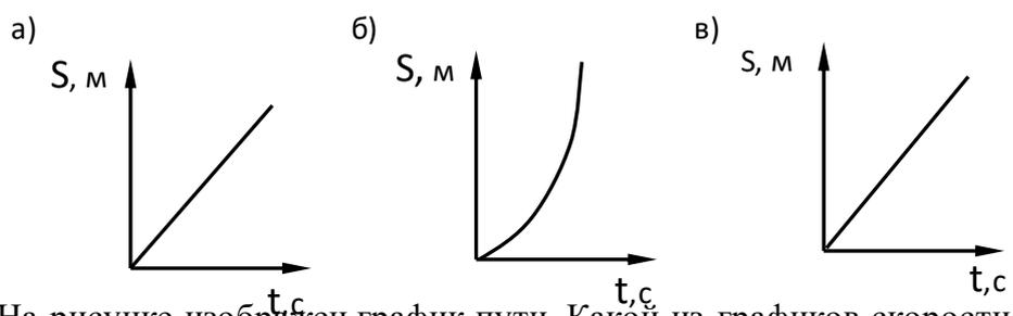
7) На рисунке изображен график пути. Какой из графиков скорости соответствует равномерному движению?
