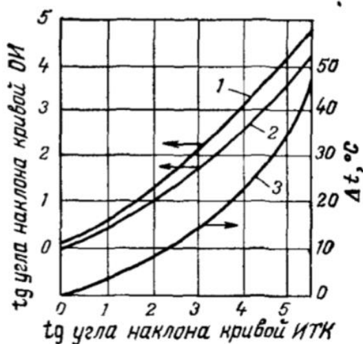
Рисунок 4 – График для построения кривых ОИ нефтяных фракций \Delta t – разность между температурами выкипания 50% по ИТК и ОИ; 1 – кривая для определения \text{tg} угла наклона кривой ОИ при помощи разгонки по ГОСТ; 2 – то же при помощи разгонки по ИТК; 3 – кривая разности температур выкипания 50% по кривым ИТК и ОИ
