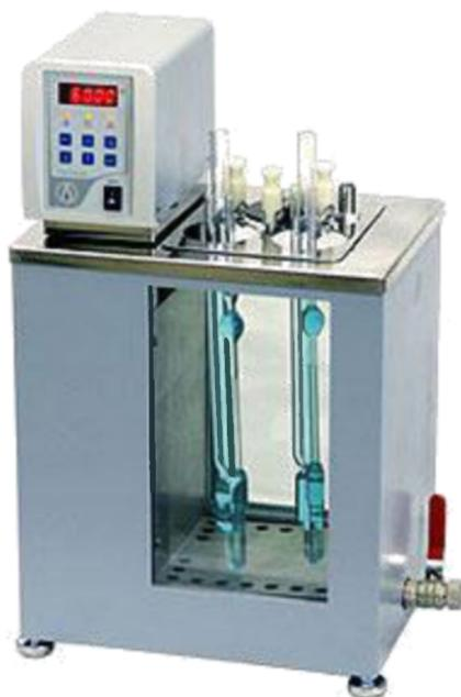
Рис. 4. Термостатирование вискозиметров.
