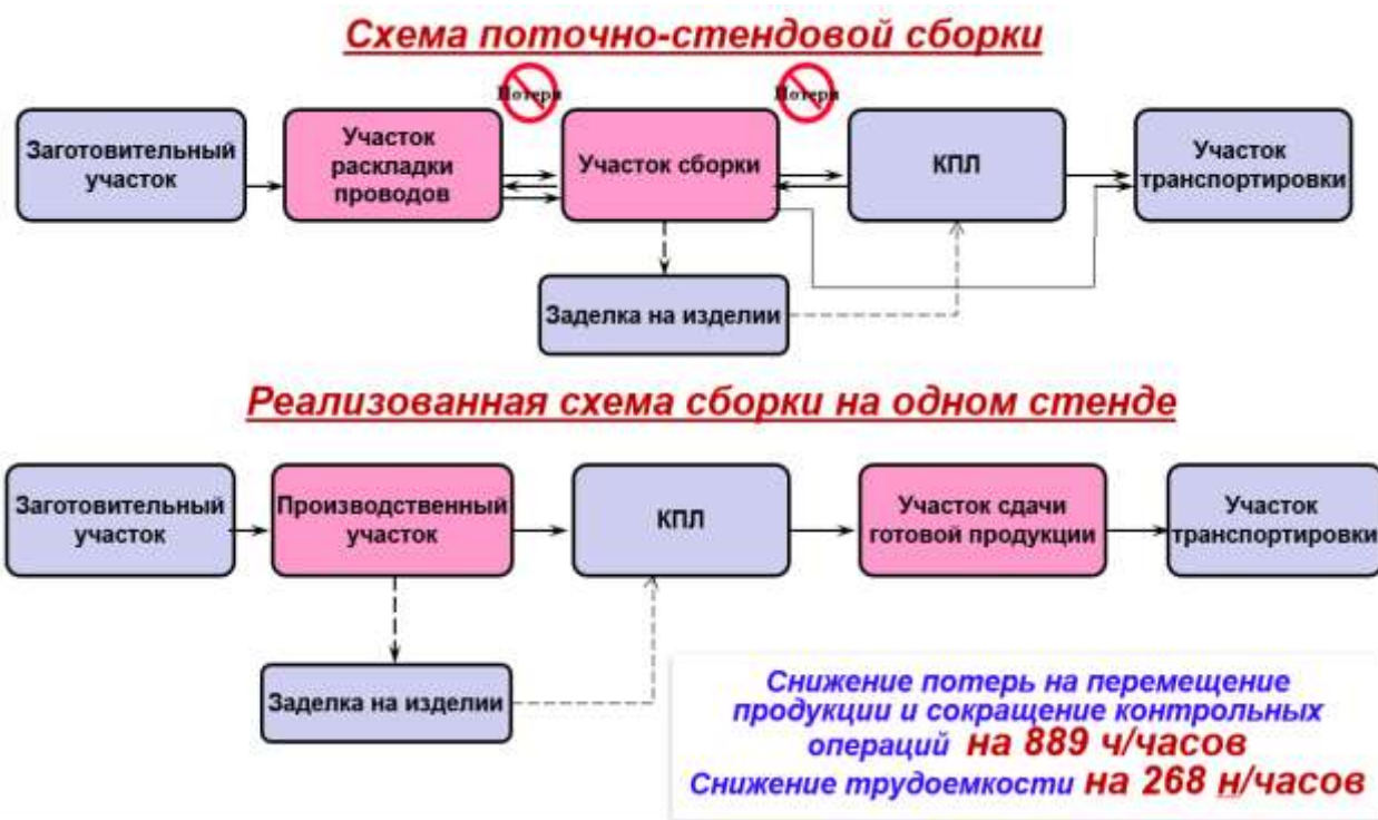
Рис. 4 Сравнительный анализ схем сборки жгутов на примере цеха №55 Филиала ПАО "ОАК" - "КНААЗ им. Ю.А.Гагарина"
