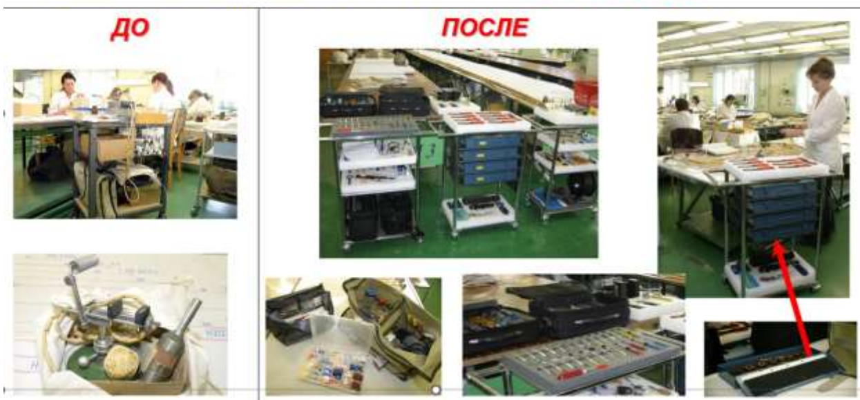
Рис. 9 Сравнительный анализ оптимизации подбора инструмента – комплектования наборов инструмента для выполнения узко-специализированных заделок на примере цеха №55 Филиала ПАО "ОАК" - "КНААЗ им. Ю.А.Гагарина"
