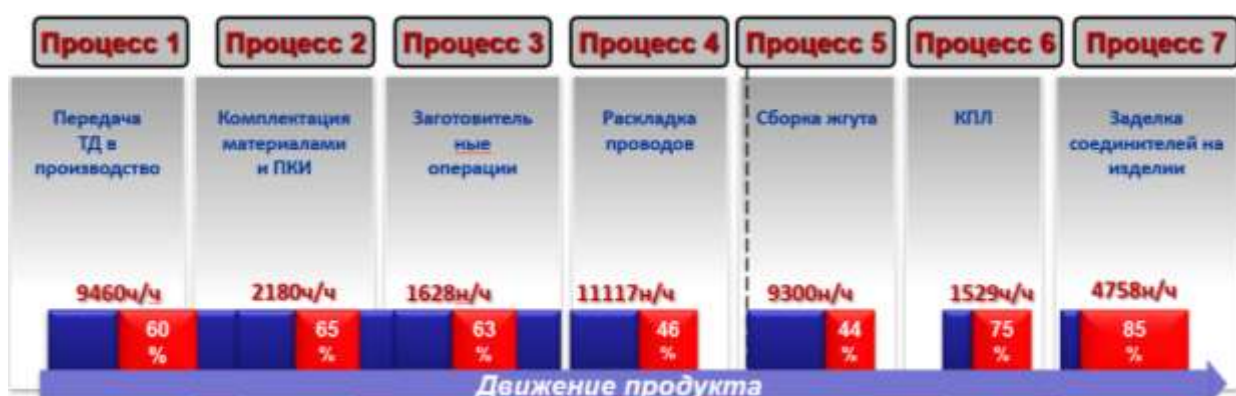
Рис. 2 «Прошлого состояния» процесса изготовления кабельной сети самолета на примере цеха №55 Филиала ПАО "ОАК" - "КнААЗ им. Ю.А.Гагарина"
