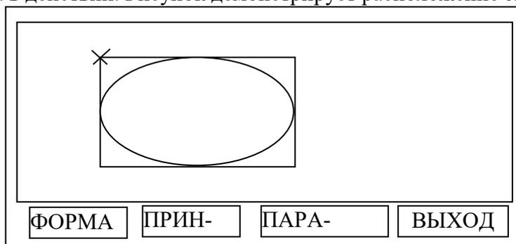
На форме этой простой программы находятся всего два элемента. Кнопка ФОРМА получает контекст устройства для формы и выводит сведения по этому контексту. Кнопка
