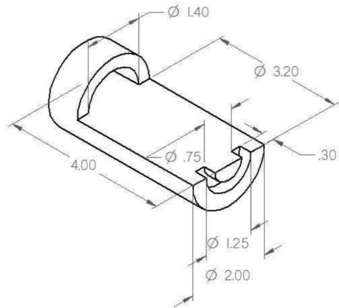
**Рисунок 3.7 Образец детали для моделирования. «Тело вращения»**
