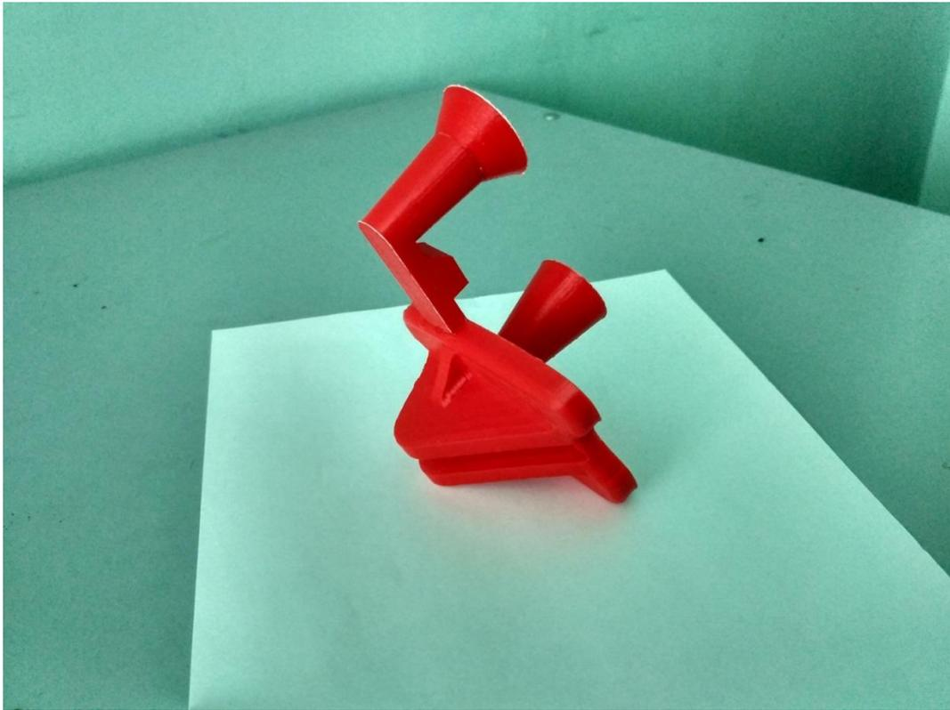
Рисунок 3.20 - Модель отливки с прикрепленной литниковой системой
