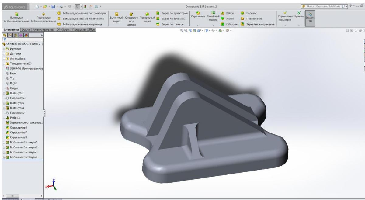
Рисунок 3.13 – Окно программы SolidWorks с моделью отливки
