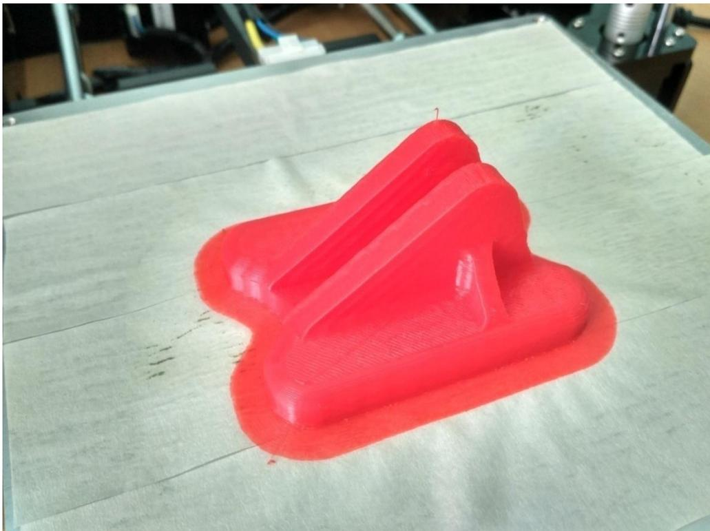
Рисунок 3.19 – Модель отливки
