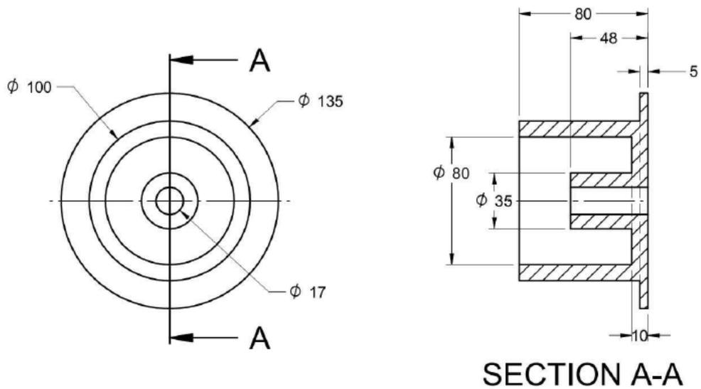
**Рисунок 3.8 Образец детали для моделирования. «Тело вращения»**
