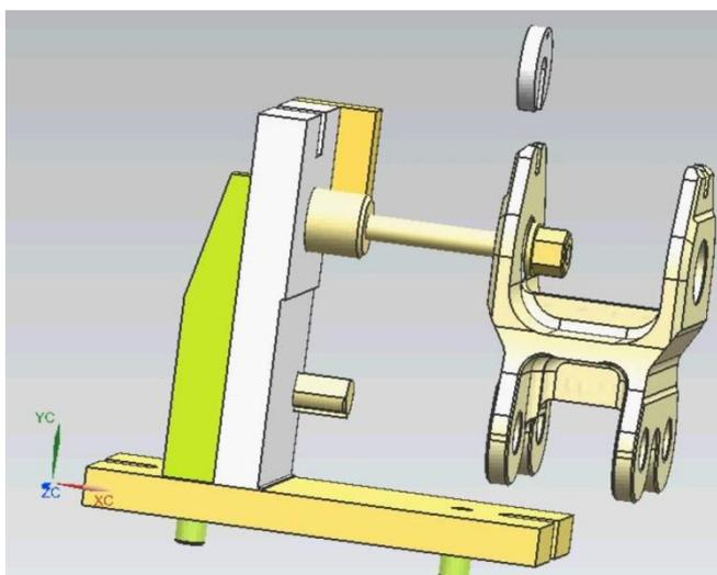
Рисунок 2 - Момент движения закрепления-раскрепления заготовки.
