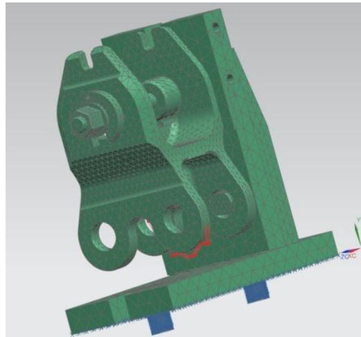
Рисунок 3 – Сеточная модель с закреплением и нагружением.
