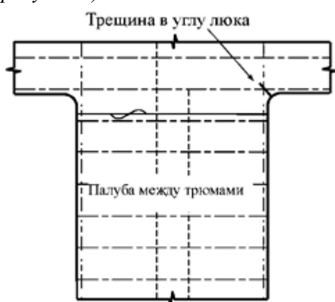
Рисунок 1 – Трещина в конце люка
