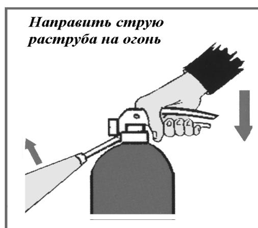
Рисунок А.3– Приведение углекислотного огнетушителя в действие
