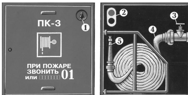
1 – место хранения ключа; 2 – пульт дистанционного включения насоса-повысителя; 3 – пожарный кран; 4 – пожарный рукав; 5 – пожарный ствол
