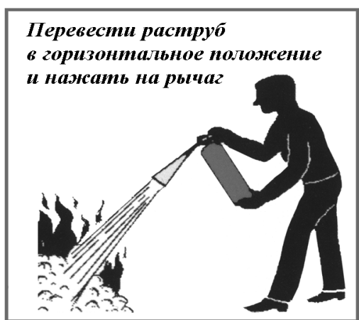
Рисунок А.3– Приведение углекислотного огнетушителя в действие
