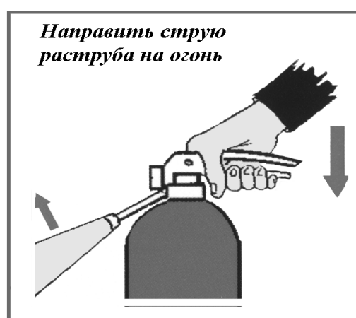
Рисунок А.3– Приведение углекислотного огнетушителя в действие
