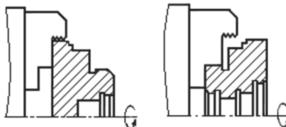
Рис. 2.11. Применение кулачков для полной обработки фланца за две установки
