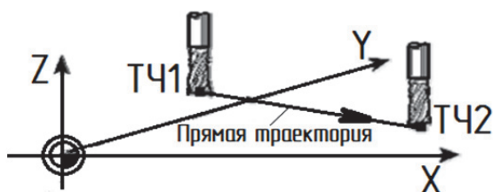
Рис. 3.22. Линейная интерполяция с ускоренным ходом от точки 1 к точке 2
