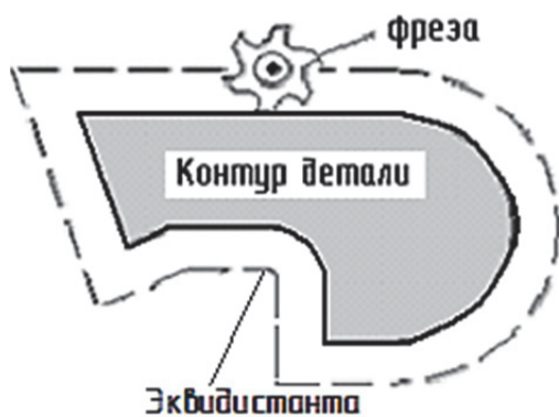
Рис. 3.27. Коррекция радиуса инструмента
