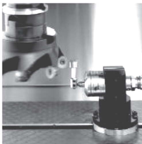
Рис. 4.8. Датчик Renishaw TS-27 для измерения длины и радиуса инструмента
