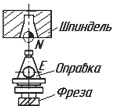
Рис. 1.7. Система координат инструмента
