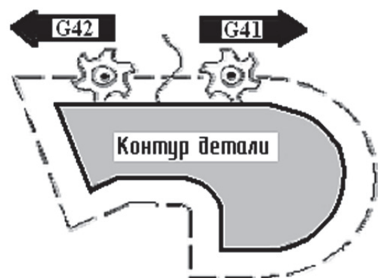
Рис. 3.28. Коррекция справа/слева от контура
