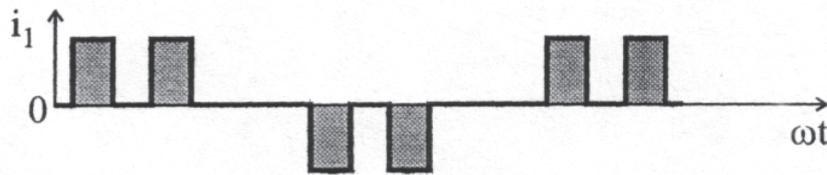
Рис. 9.6. Диаграмма входного тока мостового выпрямителя с ИК при  $RL_\infty$ -нагрузке
