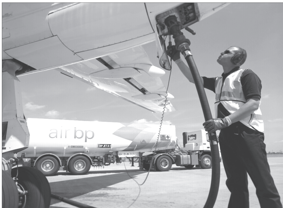
Рис. 16.7. Заправка топливом с заземлением
