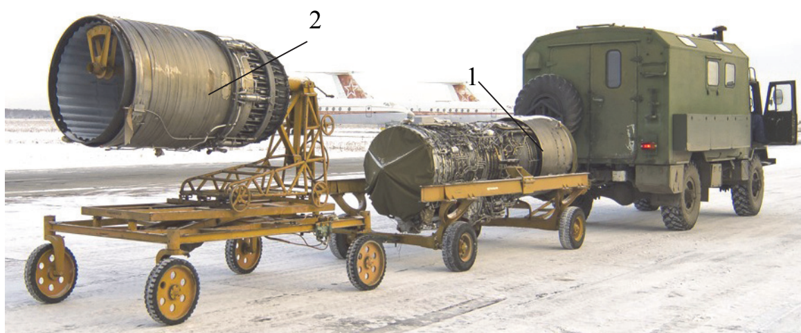
Рис. 12.1. Сравнение внешних размеров форсажной камеры и двигателя
