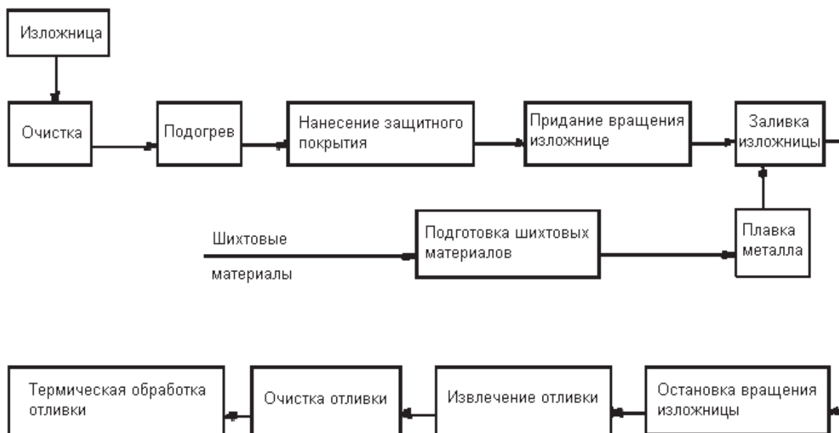
Рис. 37. Последовательность выполнения технологических операций процесса центробежного литья
