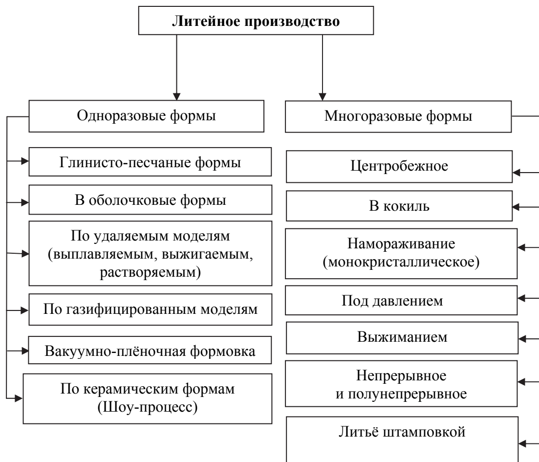
Рис. 32. Классификатор типов производства литейных изделий
