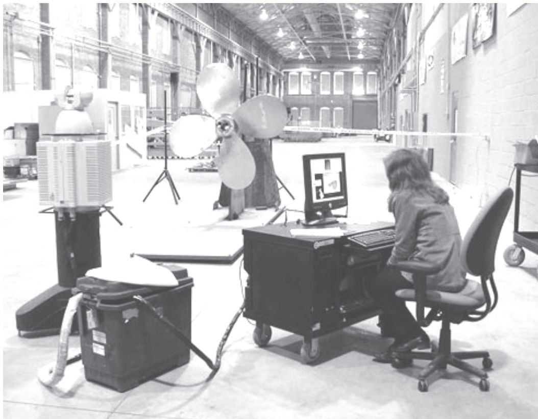
Рис. 2.31. Применение стационарного 3D-сканера для измерения геометрии гребного винта
