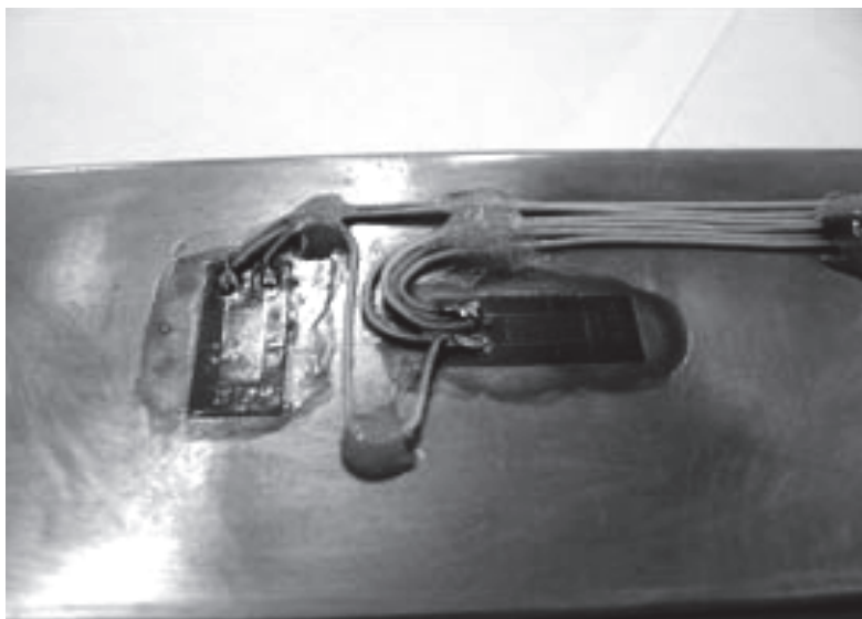
Рис. 2.23. Пример наклейки тензодатчика на деталь
