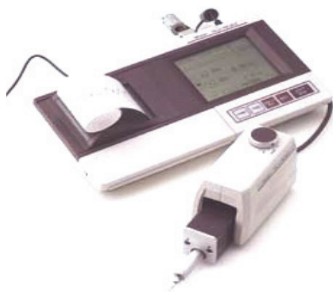
Рис. 1.2. Электронный прибор для измерения параметров шероховатости
