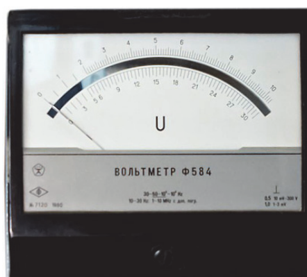
Рис. 3.4. Зеркальная вставка на шкале прибора для уменьшения параллакса
