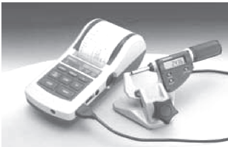
Рис. 1.3. Электронный микрометр, оснащённый мини-процессором и принтером
