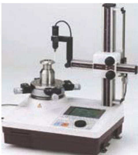
Рис. 1.4. Специальное контрольное приспособление для измерения отклонений от формы
