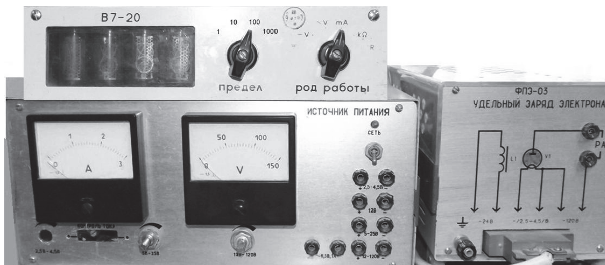
Рис. 3.5. Экспериментальная установка: 1 – кассета ФПЭ-03; 2 – источник питания; 3 – цифровой мультиметр В7-20
