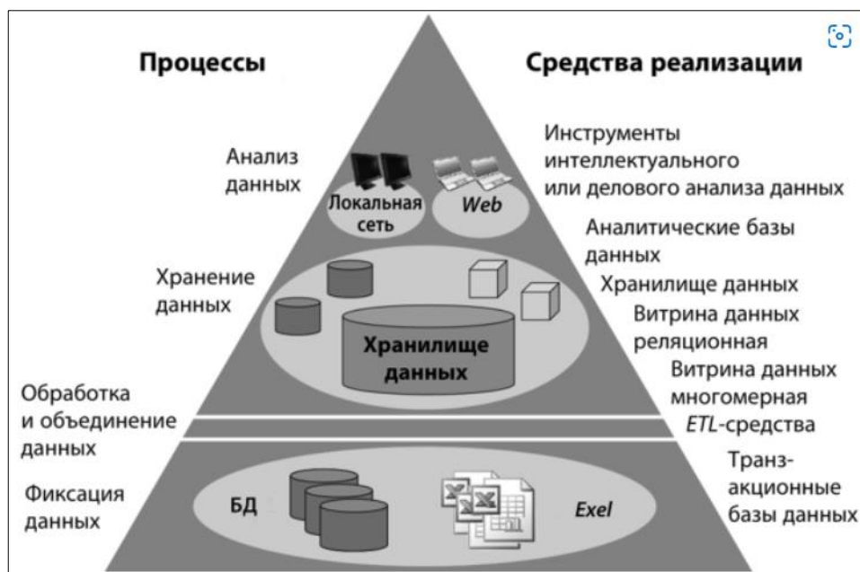
Рисунок 1 – Архитектура ИАС в обобщенном виде
