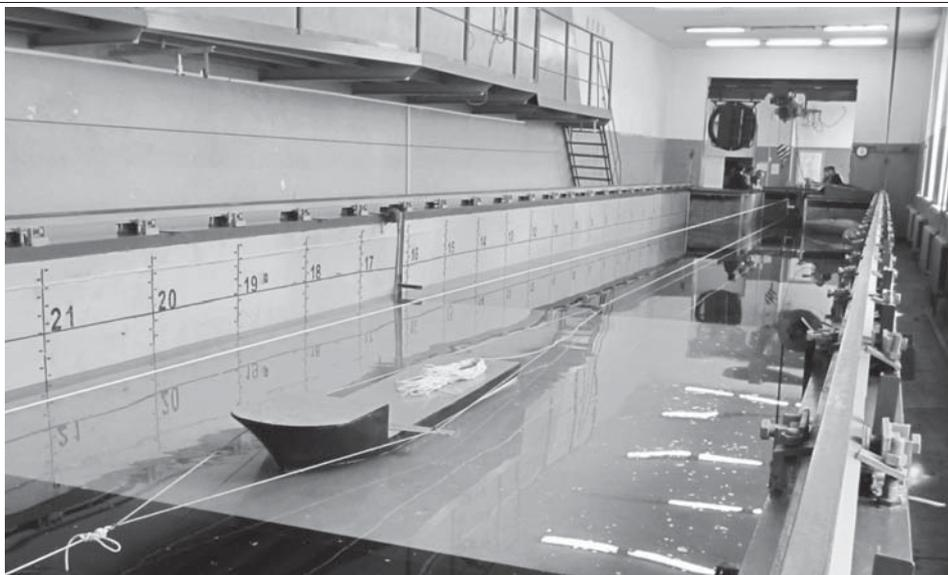
судов на линиях Северного морского пути в замерзающих районах РФ. Предполагается совершенствование научно-методической базы прогнозирования и повышения эффективности ходкости транспортных судов ледового класса на чистой воде и в битых льдах путем испытания моделей на базе Дальневосточного опытового бассейна КНАГТУ.
