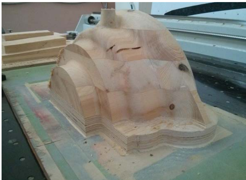
Изготовление литейной оснастки для Дальневосточного машиностроительного завода
