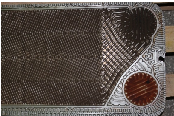
Рисунок 1 – Пластина теплообменника со следами коррозии
