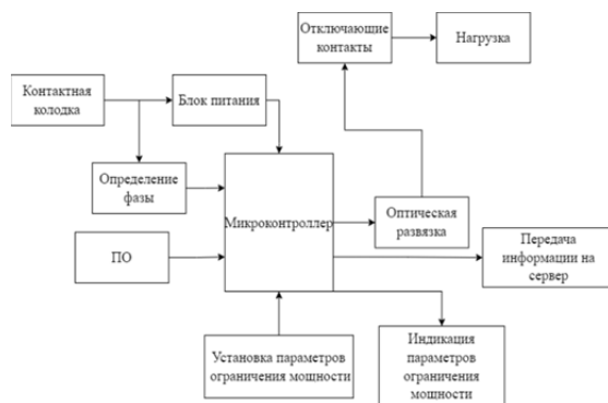
Рисунок 2- Структурная схема устройства контроля энергоснабжения с функцией ограничения мощности
