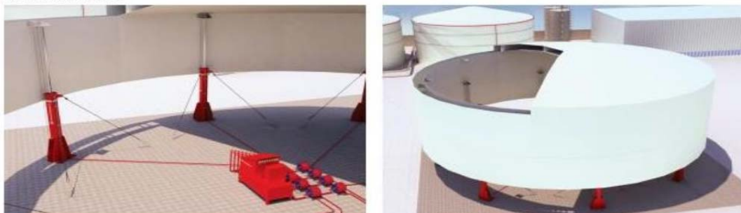
Рисунок 1 – Пример подъема резервуара домкратами
