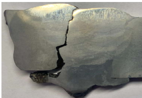
Рисунок 3 – Образец, подготовленный для оценки структурных составляющих сварных соединений
