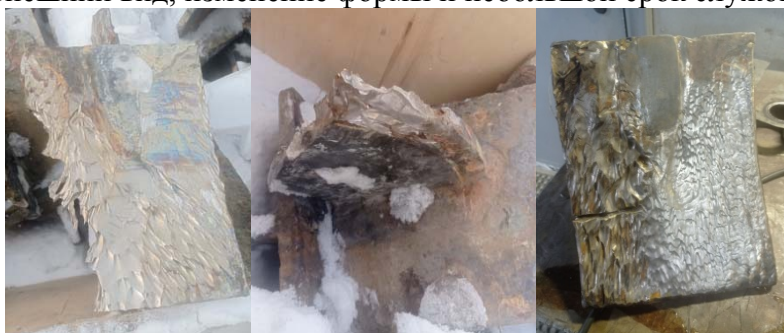
Рисунок 2 – Аварийный износ титановых лопаток
