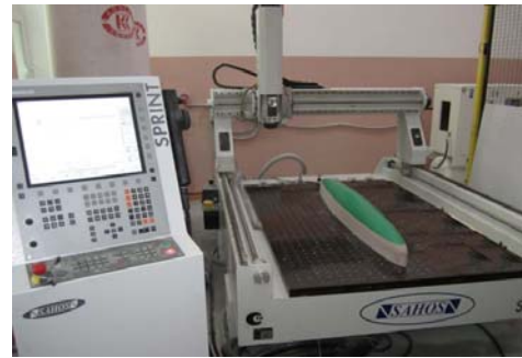
Рисунок 4 – Изготовление моделей на 3D фрезерном станке с ЧПУ
