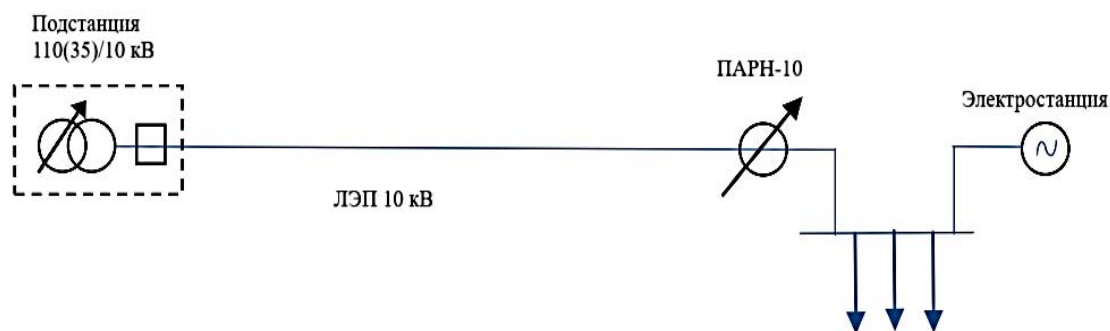
Рисунок 1 – Схема электроснабжения в упрощенном виде
