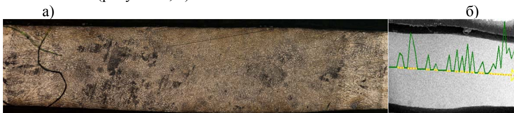
Рисунок 2 – Металл шва и дендритная структура образца 2.1 (а), линейное распределение азота в металле шва и в зоне термического влияния (б)
