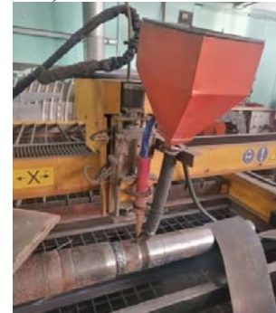
Рисунок 2 – Вращатель для вала (а), сварочная горелка и бункер для флюса (б), установленные в программируемый порталный станок
