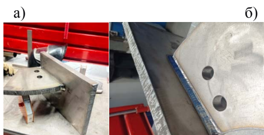
Рисунок 4 – Изготовление лопатки на производстве: а – сборка на прихватки; б – сварка деталей
