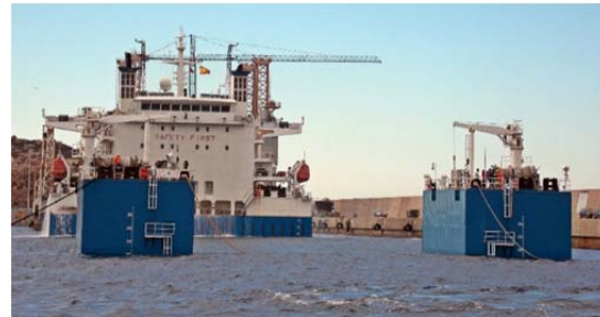
Рисунок 3 – Погружение в воду грузовой зоны
