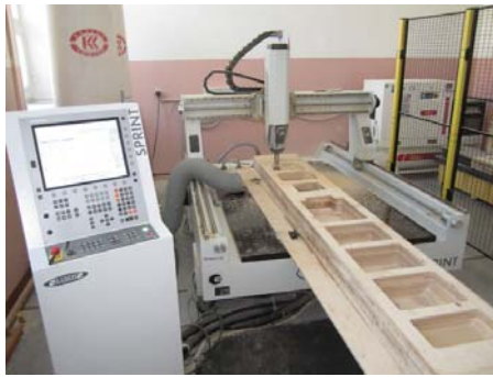
Рисунок 4 – Изготовление моделей на 3D фрезерном станке с ЧПУ
