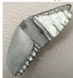
Рисунок 1 – Мастер модель и отливка винта для гоночной лодки:
