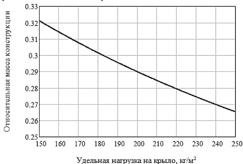
Рисунок 2 – Зависимость относительной массы конструкции МЛА от удельной нагрузки на крыло
