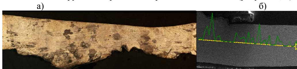
Рисунок 3 - Металл шва и дендритная структура образца 1.1(а), линейное распределение азота в металле шва и в зоне термического влияния (б)
