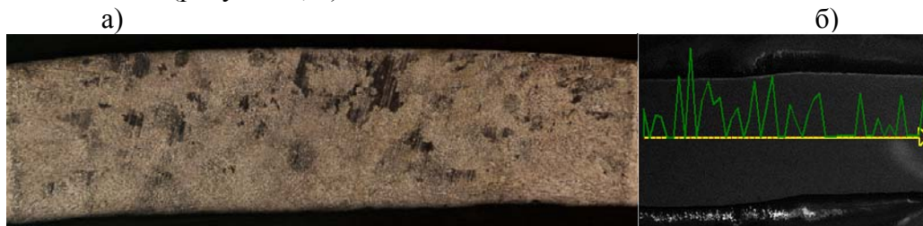
Рисунок 1 – Металл шва и дендритная структура образца 3.1 (а), линейное распределение азота в металле шва и в зоне термического влияния (б)
