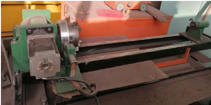
Рисунок 2 – Вращатель для вала (а), сварочная горелка и бункер для флюса (б), установленные в программируемый порталный станок
