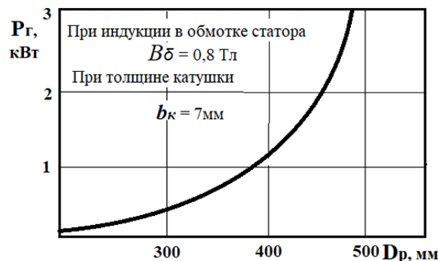
Рисунок 3 – Зависимость между мощностью и диаметром ротора низкооборотного МЭГ при постоянстве толщины катушек и магнитов
