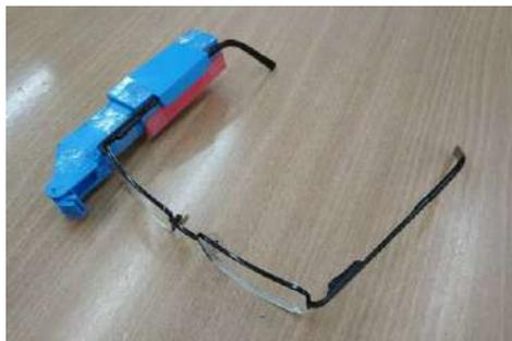
цепи, затем эти показания при помощи зеркал и отражателя выводятся на линзу его очков, также для записи показаний имеется камера, фиксирующая показания и место их измерения, тем самым избавляя от необходимости записывать показания на бумагу.
