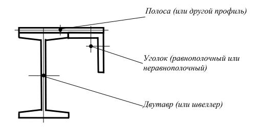
Пример схемы поперечного сечения стержня к задаче 1
