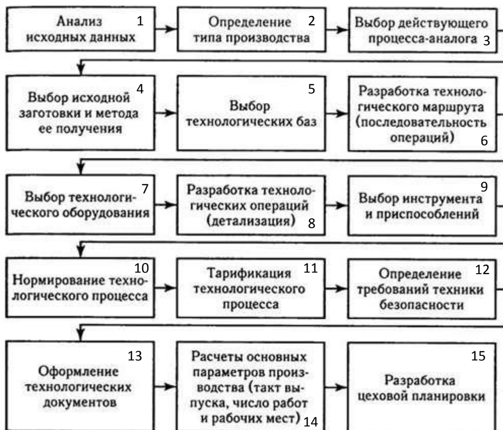
Рисунок 2 – Общая схема последовательности разработки технологического процесса
