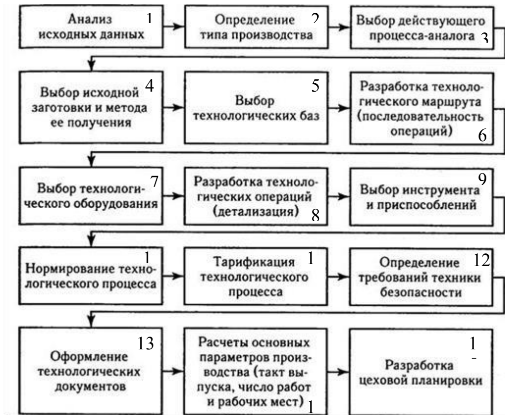
Рисунок 2 – Общая схема последовательности разработки технологического процесса
