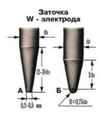
Вопрос 8 На рисунке А и Б указана заточка вольфрамовых электродов при сварке в среде аргона, определите заточка под буквой Б используется для сварки на...
