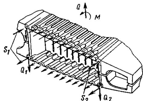
3. Какие функции выполняют стрингеры в крыле? Охарактеризуйте типовые профили стрингеров.
