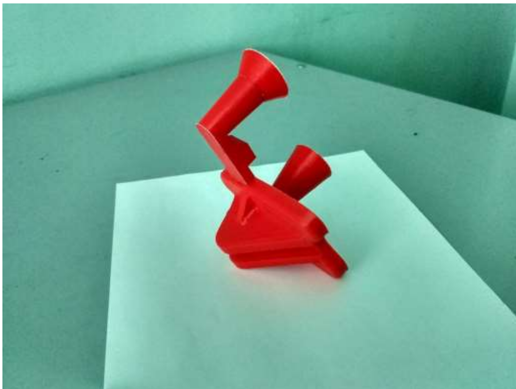
Рисунок 3.9 - Модель отливки с прикрепленной литниковой системой
